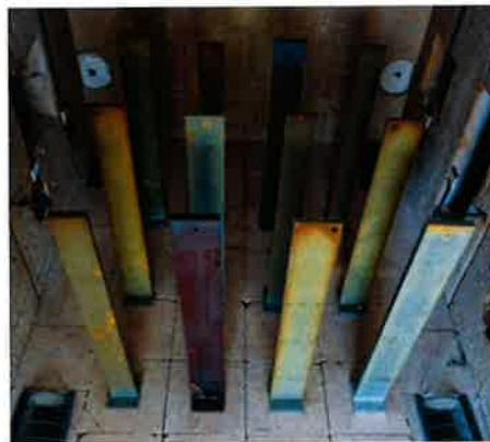
Vergleich der Proben vor (links) und nach (rechts) dem zweiten Brandversuch.
